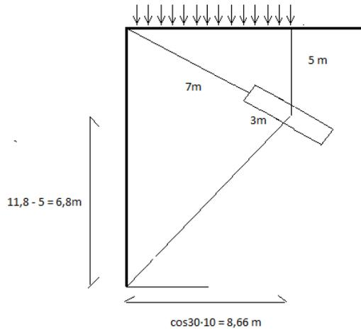
A continuación podemos establecer el equilibrio de las fuerzas de reacción conocidas, los empujes de ambos lados de la rebanada o cuña, el peso de la misma y la reacción con la base de la superficie de rotura.
